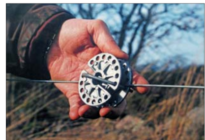
Trådspännaren gör det enkelt att hålla eltråden sträckt.
